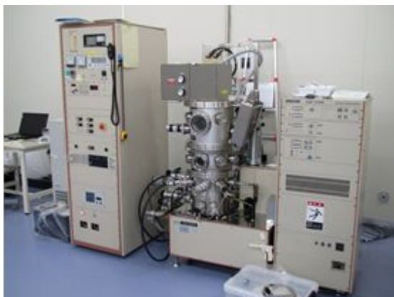
図4 高エネルギー加速器研究機構内に整備された電子ビーム蒸着装置
