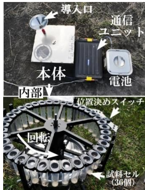
図2 自作・運用した自動火山灰採取装置
