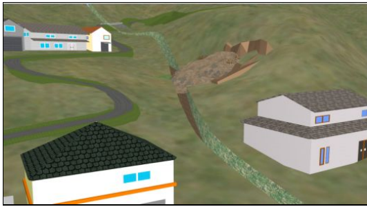
(b) 斜面崩壊による土砂ダムの形成
