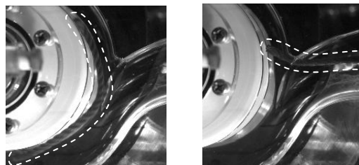
(a) ケーシング内での滞留 (b) 舌部での引っ掛かり
