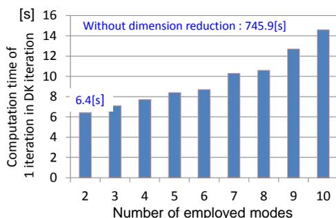
表 2 から明らかなように、採用次数が少なくなるにつれて、イタレーション計算の 1 回あたりの計算時間が減少する傾向にある。これは採用次数が減少することによって、最初に得られるニュートン・オイラー型の運動方程式の次数が減少するためであると考えられる。また、低次元化を施していない場合は 1 回の計算で 745.9[s]の時間を要し、低次元化を施した場合は 10 次モードまで採用したと
