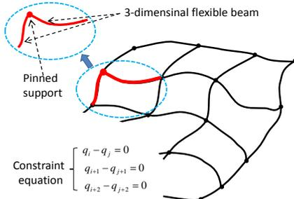
図6 3次元柔軟梁で構成されるグリッド構造
