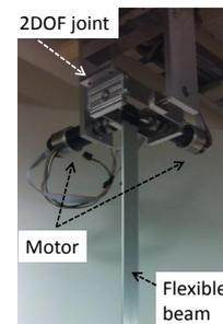
図8 3次元柔軟梁に関する実験装置の機構部
