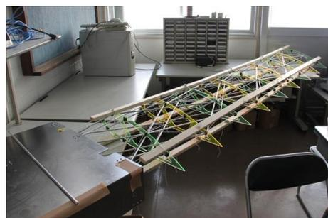
Fig.3 テンセグリティ翼構造
