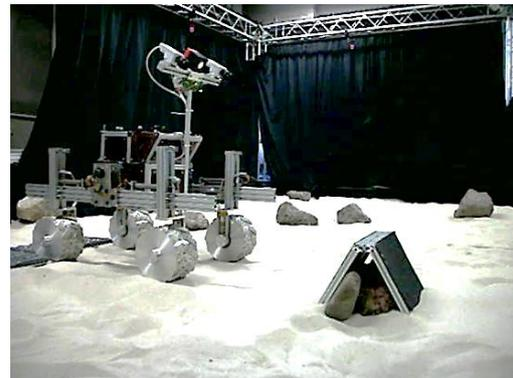
図 8：障害物乗り越え実験の一例
