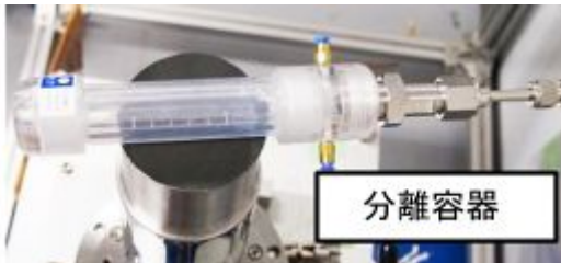
図6 水平方向磁場を利用した磁気アルキメデス分離
