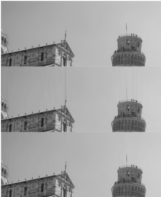
図 1 画像符号化性能の比較。(上) 通常符号化 (PSNR: 40.91 dB) (中) 従来の CAR 符号化 (PSNR: 38.40 dB) (下) 提案手法 (PSNR: 40.41 dB)
