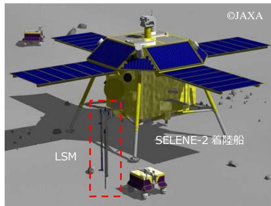
図-1 月面地盤調査装置の搭載イメージ
