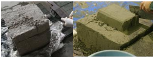
写真-4 岩床コア整形作業（十勝川（左）、然別川（右））
