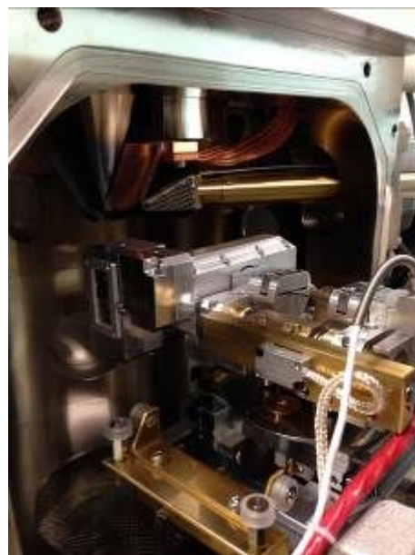
図2 FE-SEM内に設置した小型引張試験機の様子
