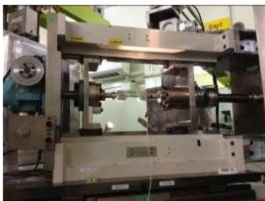
図3 中性子回折測定風景(紙面奥から手前方向に中性子ビームが導入され、写真中心部分にある試料に照射される。試料で散乱した中性子は写真の左右端にある検出器によって検出される)
