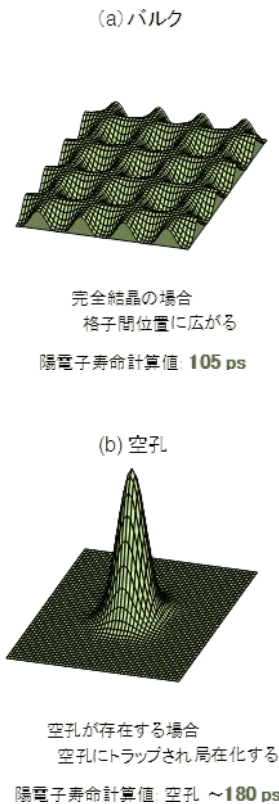
図1. 鉄中の(a)バルク(完全結晶部)における陽電子密度、(b)原子空孔に捕獲された場合の陽電子密度。
