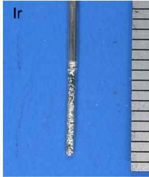
図6 CV測定後のイリジウム電極の様子。
