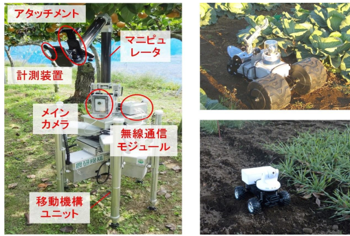
図3. 移動作業型フィールドサーバ
