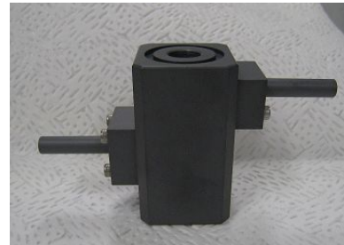
図 2 垂直照射用炭化珪素製標的容器
