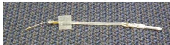
図5. 直径50μmのAV-DONE方式の刺激電極
