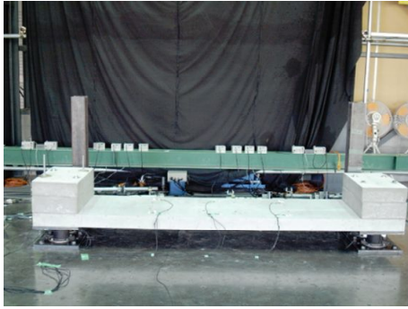
図4 免震層-床簡易試験体を用いた振動台実験
