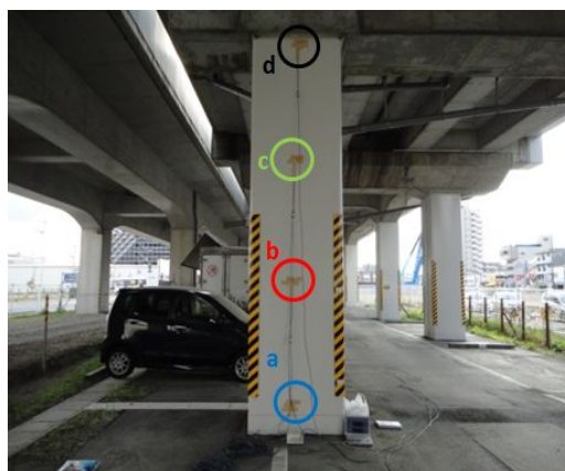
図-3: 高架橋計測風景(a~dの位置に3軸加速度センサーを配置)
