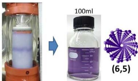
図1 (6,5)型の単一構造SWCNTの分離の様子。左の写真は、単一構造SWCNTを流し出しているところ。(Nano Lett. (2013))
