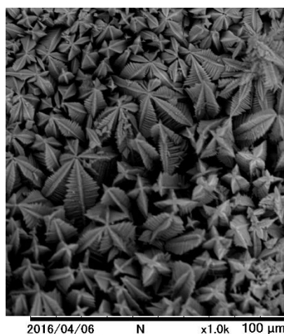
図3 樹枝結晶 (セリア) の電子顕微鏡像
