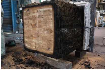
図 小型試験による予測法で開発した1時間耐火構造梁(燃えしろ・中心部は無処理集成材、燃え止まり層は準不燃材料相当難燃処理木材)の加熱実験後の状況
