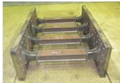
図3 研究の出口に設定している制震ダンパーの一例
