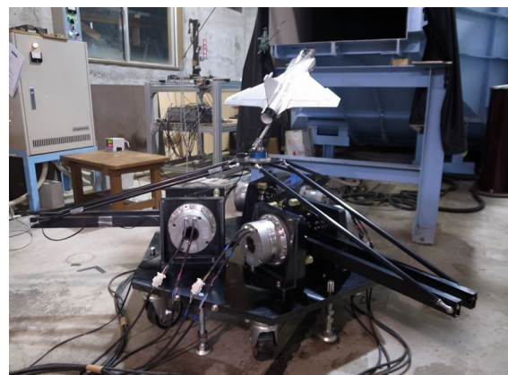
図1 東北大の6自由度ロボット (HEXA-X2)
