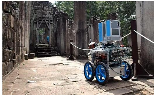
図4 移動型レーザ計測システム
