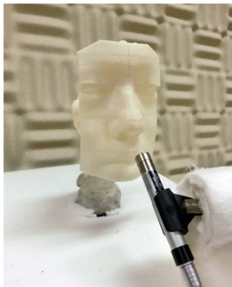
図1: 鼻腔・副鼻腔実体模型の音響特性の計測の様子
