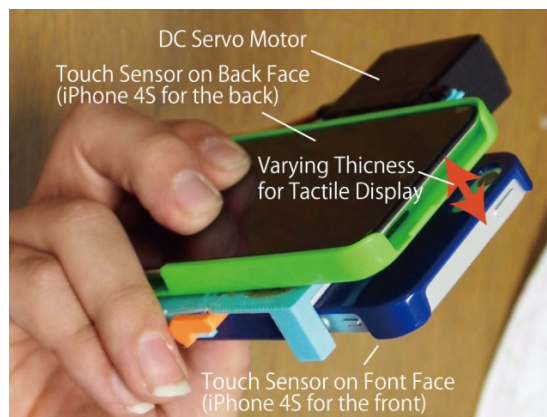
図7 スマートフォンを2枚重ねて表裏のタッチパネルで指位置を検出できるようにして、2枚のスマートフォンの間隔をモータで変えることにより、厚みを変えて触覚情報を提示する試作。
