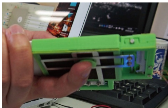
図8 スマートフォン裏側で二次元に動いて指に力を提示する機構の試作。
