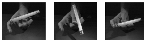
図 高速度カメラで撮影した器用な物体操作(ペン回し)の高速度撮影結果(2000fps, 手への物体の作用がわかる)
