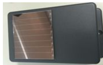
図 4.4 ソーラ充電システム
