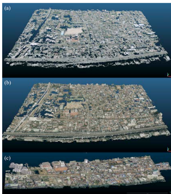
図-5 (a) 直下視の被災前モデル, (b) 直下視の被災後モデル, (c) 直下視と斜め写真を統合したモデル
