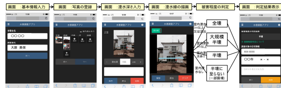
図3 水害による建物被害調査システム
