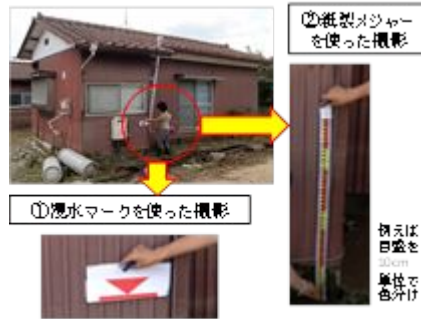
図4 水害調査システム試行の様子
