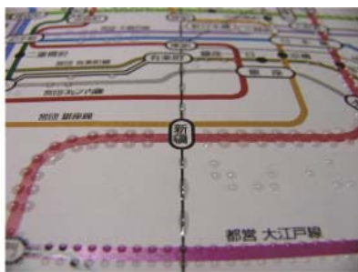
図 1 紫外線硬化樹脂インク製点字
