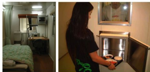
写真1 ヒューマンカロリメータ 密閉室で間接熱量測定中(左)、食事は二重扉を介して供給する
