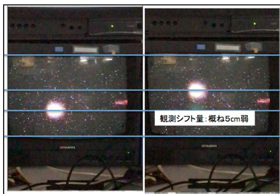
図： 100MeV陽子軌道制御実験結果：キッカー非励磁（左図）と励磁（右図）時の軌道変位量は約5cmであり、想定通りの結果が得られた。
