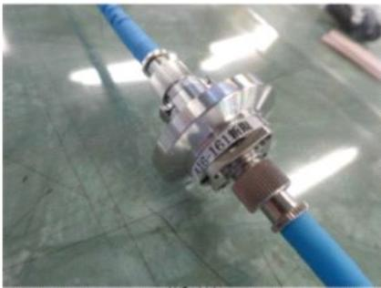
図7 . 大気側 (図手前側)、真空側 (奥側) にそれぞれFCコネクタが付属したエアタイトな真空アダプター。
