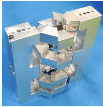
図6 板ばねの材質と配置を最適化した 試作弾性回転ジョイント
