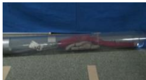
図11 配管内の障害物の乗り越え動作
