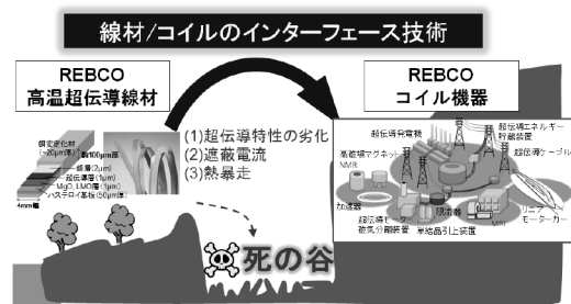
図2 REBCO線材/コイルのインターフェース技術
