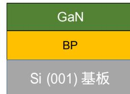
図2. Si(001)/BP/GaN試料の断面構造
