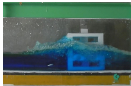
図1 建築物内に浸水する津波の様子
