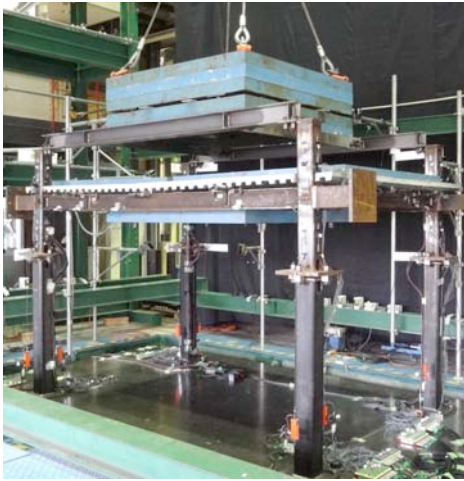
図 8 2 層骨組による振動台実験
