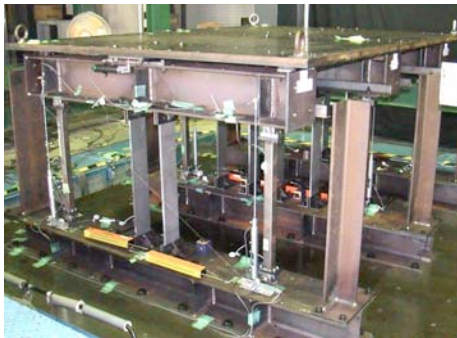
図4 1層小型模型による振動台実験
