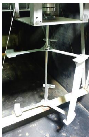
図-15 回流水槽中の1枚翼ダリウス水車
