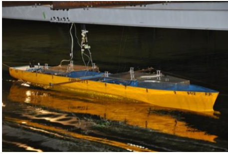
図 3 波浪中動揺試験の様子
