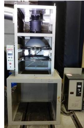
図 1 1kWth 太陽シミュレータ
