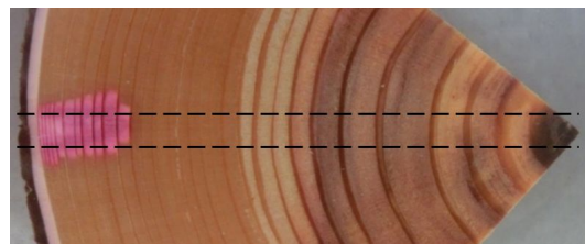
図2 溶液注入後のスギ試料 自由水が移動した部位は酸性フクシンの赤色染色で判断できる。点線は分析を行った範囲を示す。
