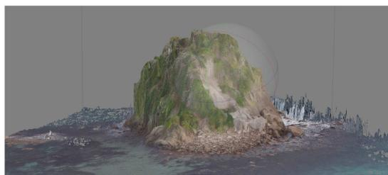
図 5 ドローンにより撮影された空撮画像から構築した 3D モデル
