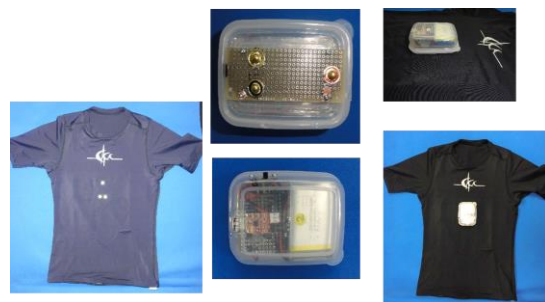
図2 着衣型センサと無線送信機
