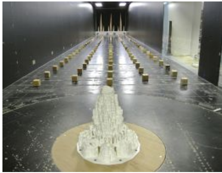
Fig.6 風洞試験の様子
