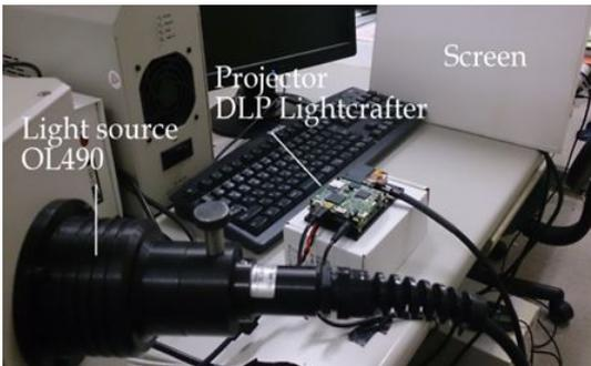
図4 分光プロジェクタを用いて構築したシステムの概要
