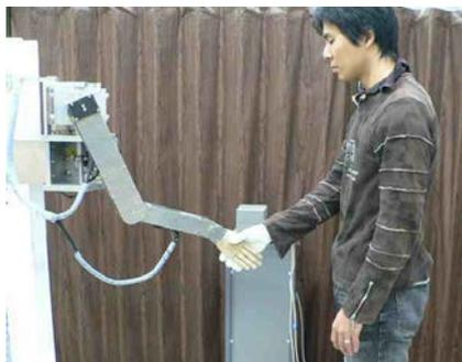
図2 握手ロボットによる握手動作
